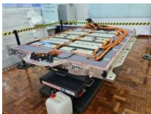
Figuras 3 e 4: Bateria de um veículo elétrico e cabos de alta tensão.
