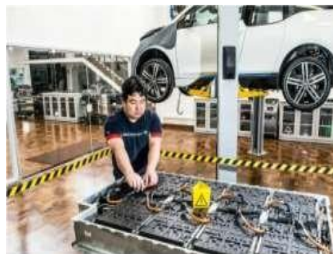
Figuras 3 e 4: Bateria de um veículo elétrico e cabos de alta tensão.
